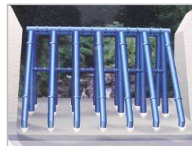
スリット型の堰堤
